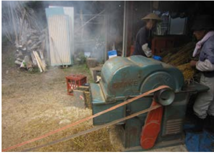
▲後ろから不要な籾殻が風で飛ばされる
