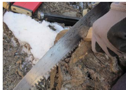
▲のこぎり：普通の作業：横引き用 (あせり出しと言い刃先が曲がっている。 木にひっかからないように) 丸太切り用：縦引き用 (刃先が立まっすぐになっている)
