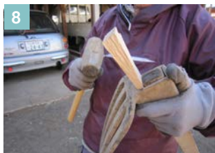
▲楔を木槌で打ち込む。打ち込む場所は、柄の内側。金属の楔は逆に柄の外側に打ち込むと、外れにくい。
