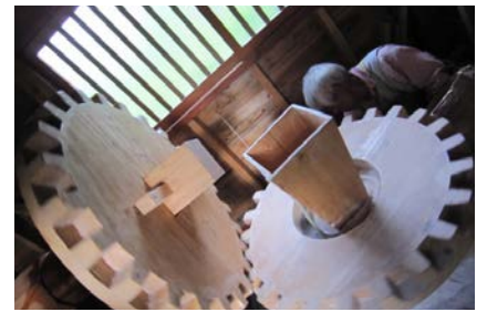
▲水車小屋の中は、木製の水力製粉器が動いている
