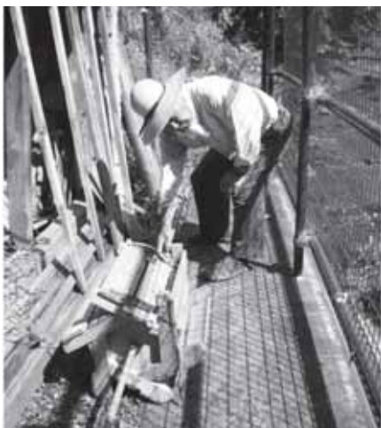
図2 イモ洗い専用の小型水車（小管村）
