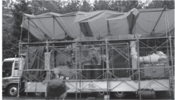
図2 バイオオイル製造プラントの開発設備： 処理能力 20kg/h の定置型流動相ベンチスケール装置（左） 処理能力 40kg/h のトラック積載可搬式 Auger 型装置（右）
